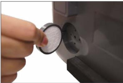
**Filtro antibacteriano externo:** Reducen el riesgo de contaminación y ayudan a mantener el equipo en óptimas condiciones de uso.
